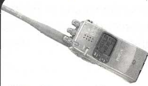
IC-W21 - Bibanda palmare 5W VHF 144-148 MHz (Rx) 138-174 MHz (Tx) UHF 430-440 MHz.
